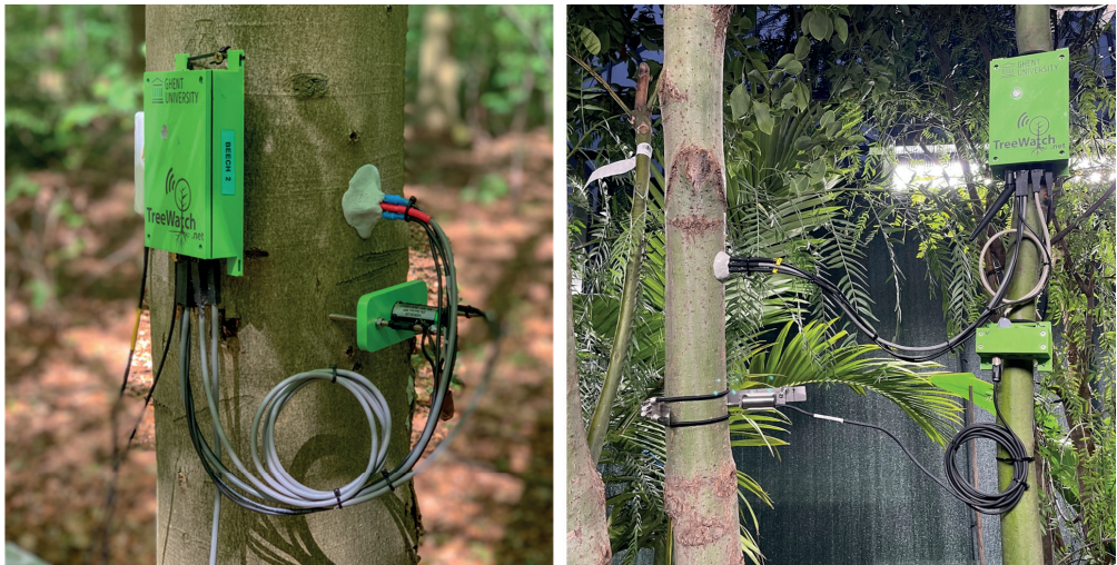
Figuur 1. TreeWatch-meetopstelling in twee contexten: links op de stam van een beuk in het UGent-proefbos Aelmoeseneie, rechts geïntegreerd in de bio-airco-opstelling van de Biennale Architettura 2025 — dezelfde technologie die zowel ecosystemmonitoring als biologische klimaatregeling mogelijk maakt.
